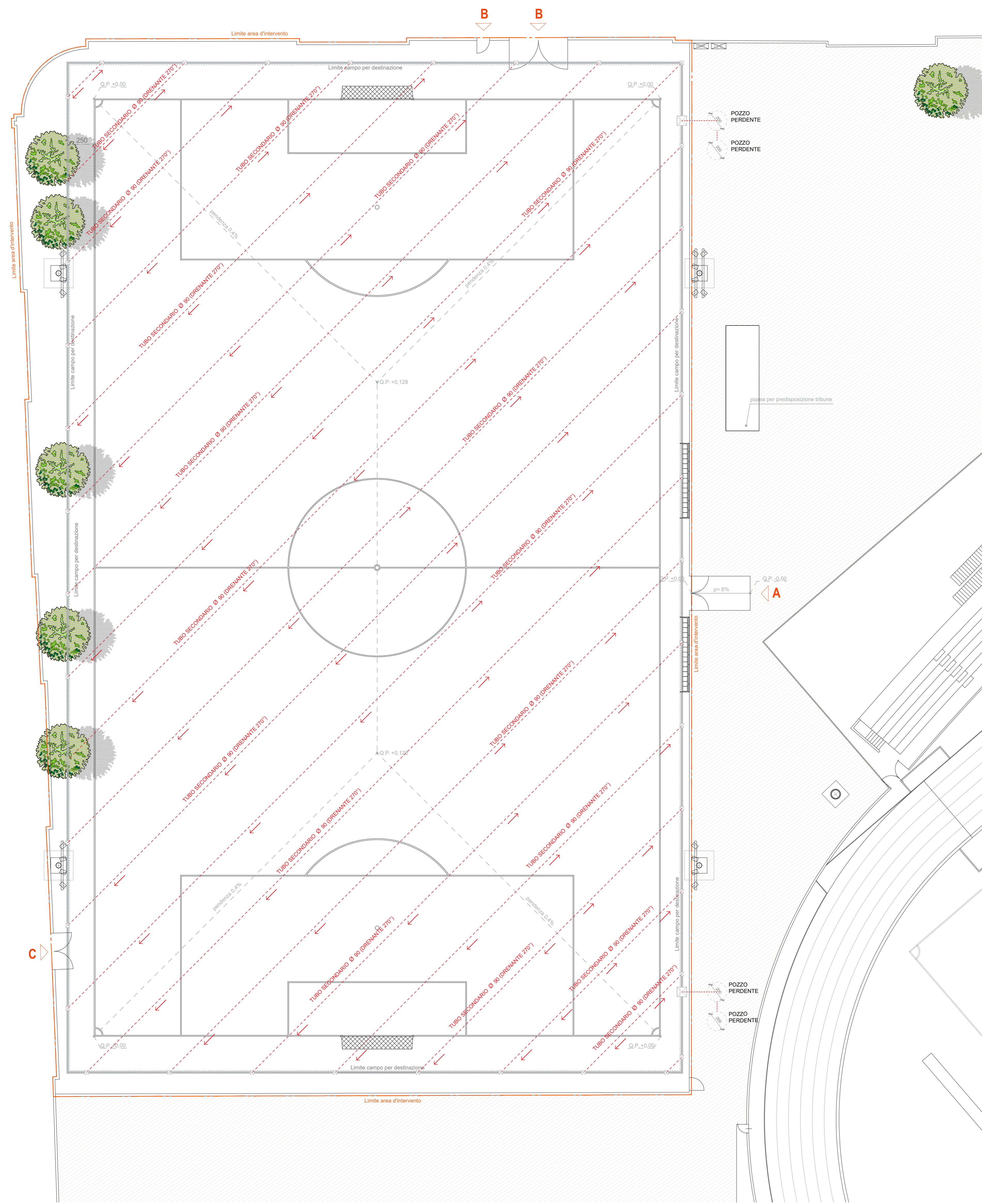
SCHEMA PENDENZE E DRENAGGIO STATO DI PROGETTO scala 1:200
